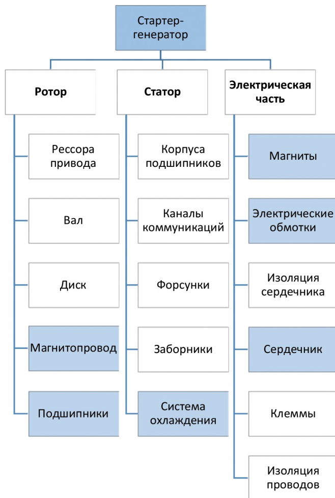
Рисунок 3. Разделение СГ на составные части. КЭ структуры выделены синим цветом
